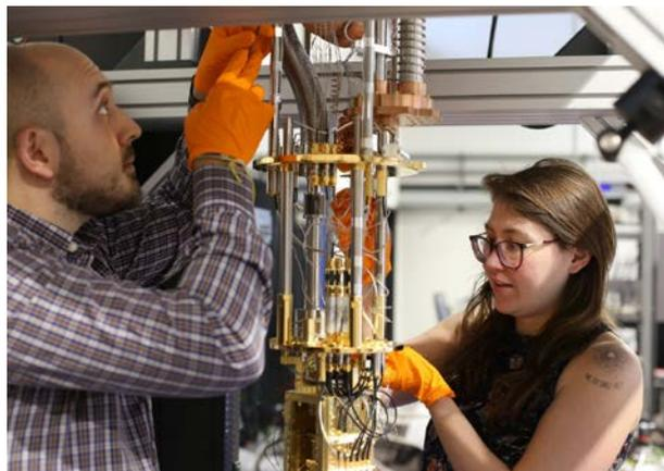
QuantaMap-Ingenieure bei der Integration des SQUID-AFM-Prototyps, der im HIQEQS-Projekt eingesetzt wird.
