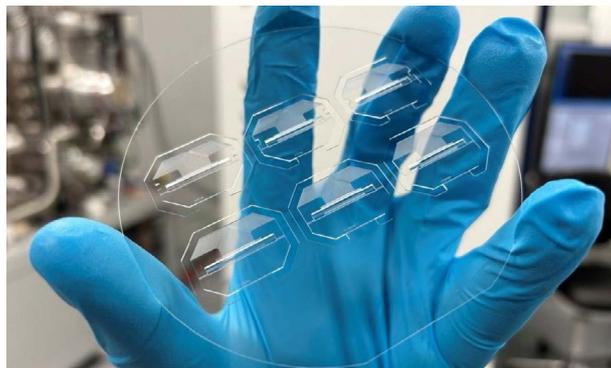
Strukturierter Glaswafer mit Ionenfallen für skalierbare Quantencomputer, hergestellt im JGUM-Reinraum.
