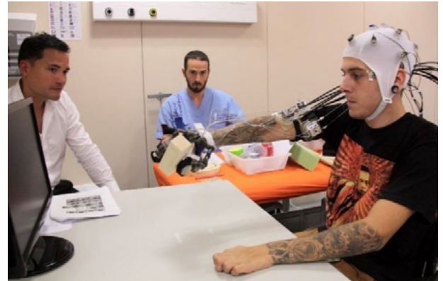
Exoskelett-Steuerung mittels eines Hirn-Computer Interface.
