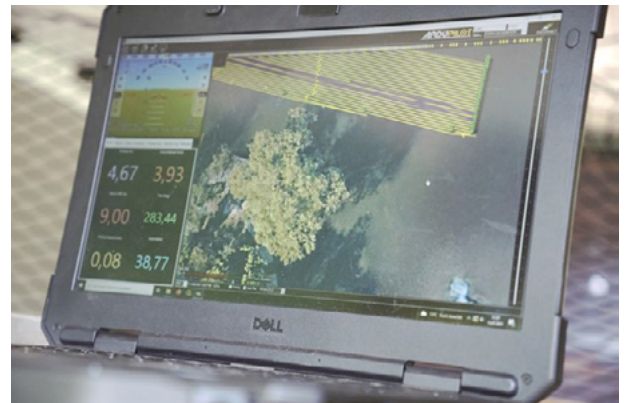
Flugcomputer im Feldeinsatz: Flugprofilplanung für eine Sondierung einer kampfmittelbelasteten Teichfläche im Ruhrgebiet.
