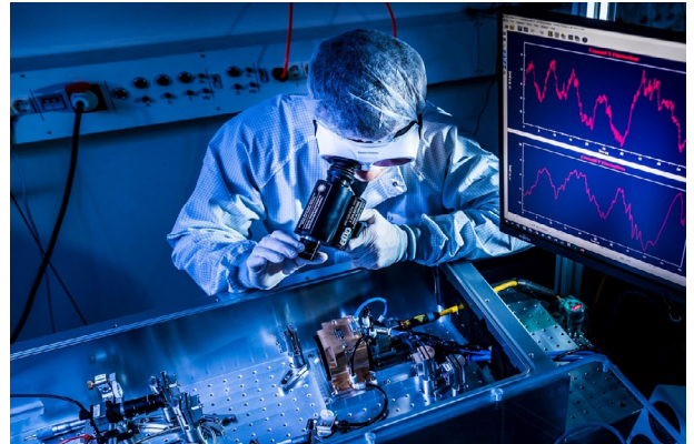
Justagearbeiten an einem abstimmbaren Lasersystem.
