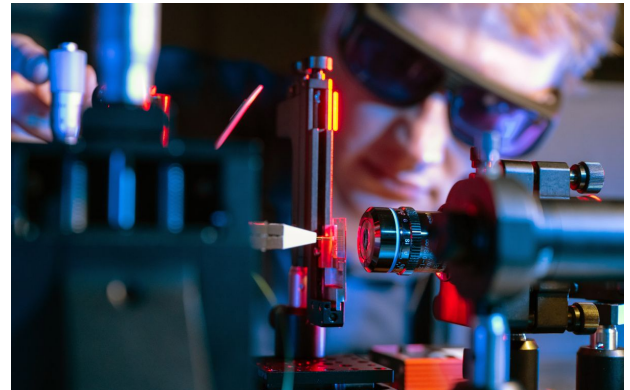
Justierung eines optischen Chips mit einer Quantenlichtquelle
