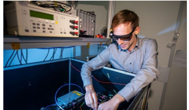
Laboraufbau eines Diamant-Quantenmagnetometers
