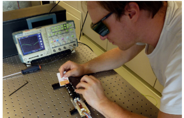
Vor dem Einsatz des OPM erfolgt die manuelle Justage der Optik.
